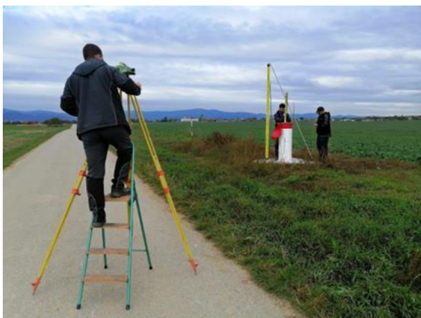
Nivelácia a skúšobné meranie na geodetickej kalibračnej základnici Viničné
